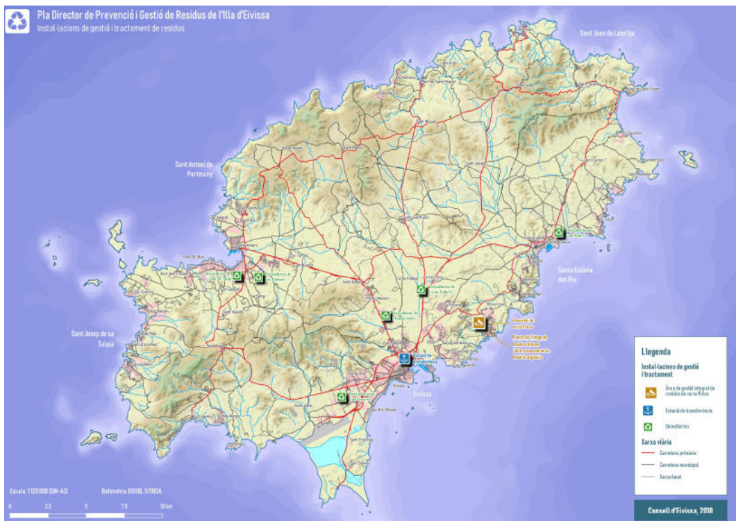
Figura 7-1. Localització de les infraestructures per a la recollida, gestió i tractament de residus no perillosos a l'illa d'Eivissa.
