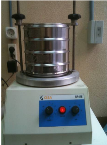
Figura 22. Torre de sedassos per realitzar anàlisi granulomètric de cadascuna de les mostres.
