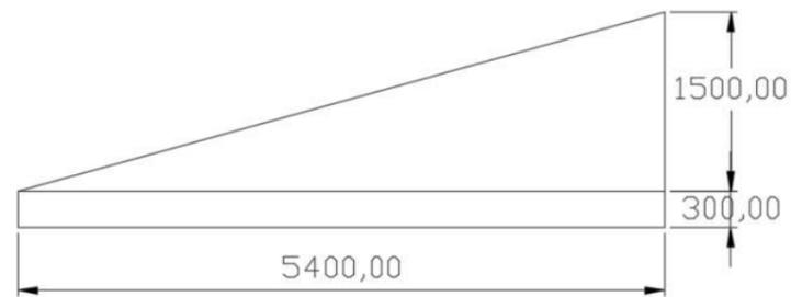
Aletas marco drenaje: sección y alzado OD-C6
